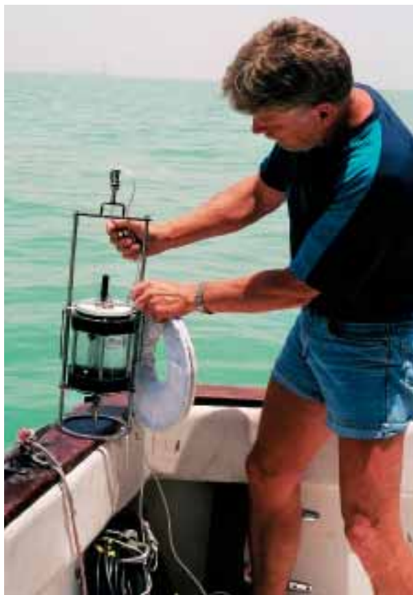
Vandprøve for kalibrering af turbiditetsmåler
