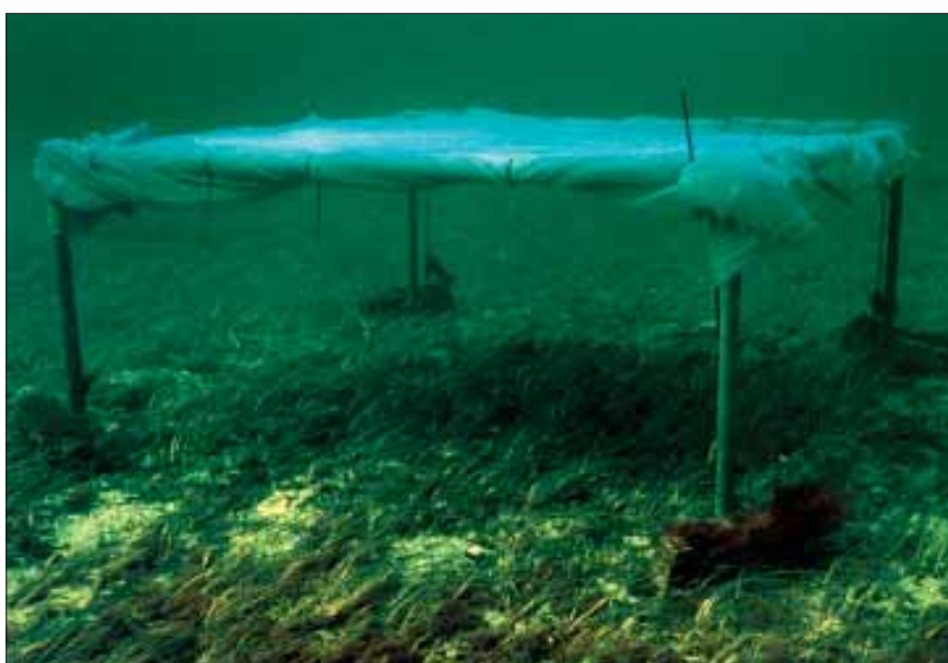
Testområde med ålegræs, som er overdækket for at illudere skygningseffekten som følge af sedimentfaner
