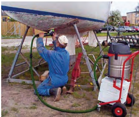
Husk at forsegle eller fjerne ulovlig bundmaling. Her er der gang i slibemaskine og støvsuger for at fjerne malingen på miljørigtig vis.
